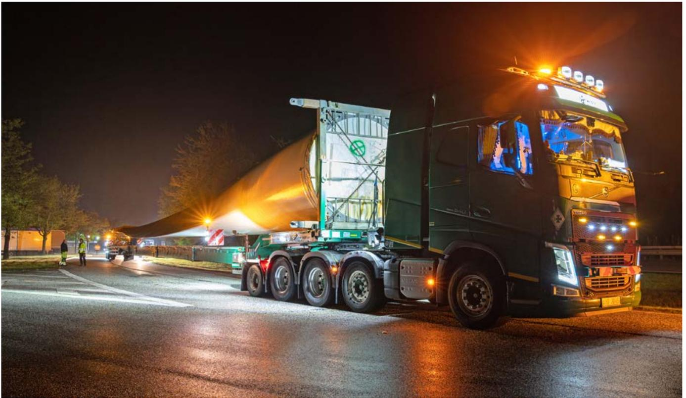
**Riesenaufwand:** Der Rotorblatttransport zu einer Windpark-Baustelle muss lange im Voraus geplant werden. Um die gigantischen Flügel zum Ziel – in diesem Fall zum Prokon-Windpark Ottenbüttel-Westermühlen in Schleswig-Holstein – zu bringen, werden mitunter ganze Kreisverkehre umgebaut und temporäre Zufahrtsstraßen angelegt.
